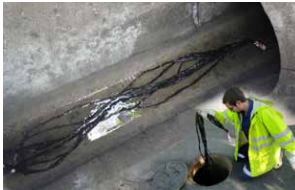
Octopus : utilisé par Veolia, ce préleveur passif, au design inspiré de la morphologie de la pieuvre, permet la capture de contaminants tel que les micropolluants dans les réseaux d'assainissement. Insérées dans le flux d'eaux usées pendant 1 à 3 semaines, les bandelettes sont ensuite récupérées et acheminées vers un laboratoire pour analyse.
