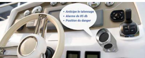
Grâce à l'innovation de R Systems, le navigateur est prévenu d'un éventuel choc à une échelle de 100 à 500 mètres en avant du bateau.
