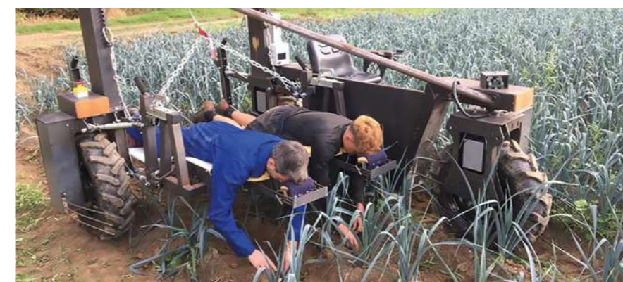
Félix et Basile Gaulier, créateurs de Romanesco (et prix coup de cœur de l'édition 2021 d'Étonnants Créateurs), testent leur prototype d'enjambeur modulaire après un an de recherche et développement : un outil polyvalent qui soulage le dos des maraîchers.
